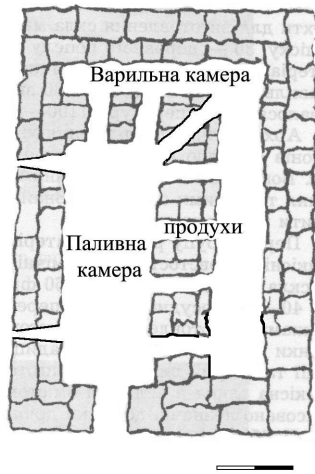
Рис. 2. Реконструкція плану склоробної печі за С. Мартинюком
